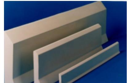
Die Formteile werden entweder auf fertigem Boden montiert (vollflächige Verklebung an Boden u. Wand), oder auf dem Rohestrich verlegt und mit Kunstharz-Bodenbeschichtung fugenlos angeschlossen.
